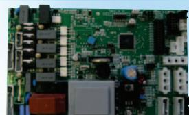
Sistema domótico para la calefacción que permite la gestión de los diferentes componentes de una instalación de calefacción: paneles solares, suelos radiantes, puffer, calentador para agua caliente sanitaria, etc.
